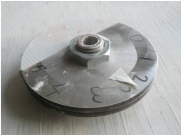
Il est fabriqué avec deux lames circulaires de 100 mm\* et une autre lame qui a été rectifiée et qui possède un diamètre d'1 mm inférieur. Celle-ci est placée entre les deux autres et est excentrée comme l'indique le schéma
