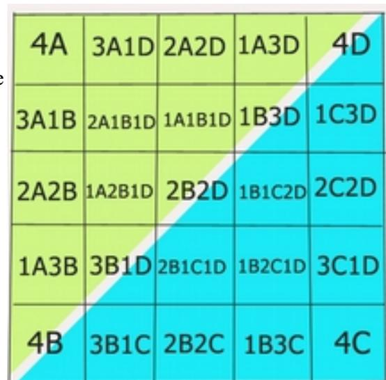
Dans Glazy en cliquant la fonction mélange biaxiale 5 lignes 5 colonnes avec les 4 recettes définies précédemment on obtient les 25 points sur le diagramme
