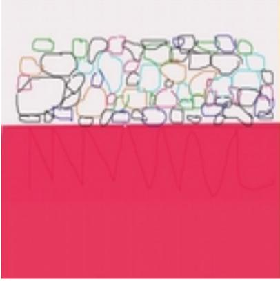
Au fur et à mesure de la montée en température il y a transformation de nos grains..... Perte de l'eau de constitution du kaolin , décarbonatation diverses,  $\text{CaCO}_3$  donnant du  $\text{CaO}$  en perdant du  $\text{CO}_2$  idem pour le carbonate de cuivre, cobalt, baryum etc
