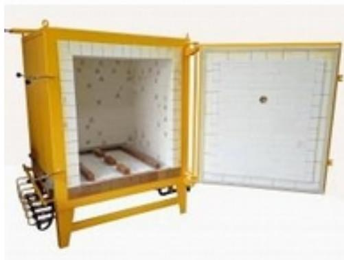
Permet le contrôle de l'atmosphère en jouant sur le rapport gaz air
