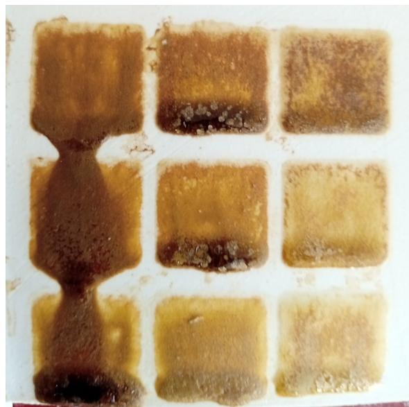
La tuile 4x4 montre la texture, matité, tressailage etc des tests.
